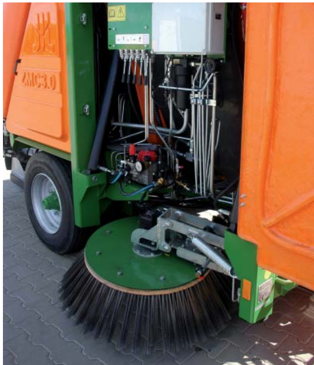
Szczotki talerzowe - regulacja kąta nachylenia zmiatania
