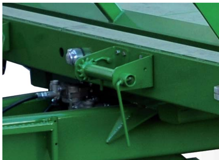
Dwa urządzenia z zapadką do zwijania pasów lub lin zabezpieczających ładunek w przyczepie PRONAR T024M
