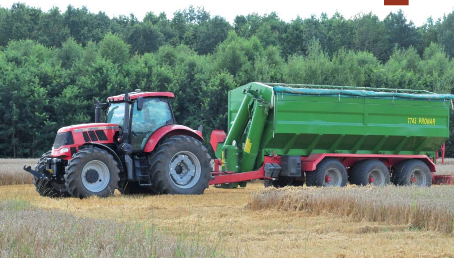
Szybki rozładunek zboża w wozach przeładowniczych PRONAR zapewnia hydraulicznie składana rura przenośnika
