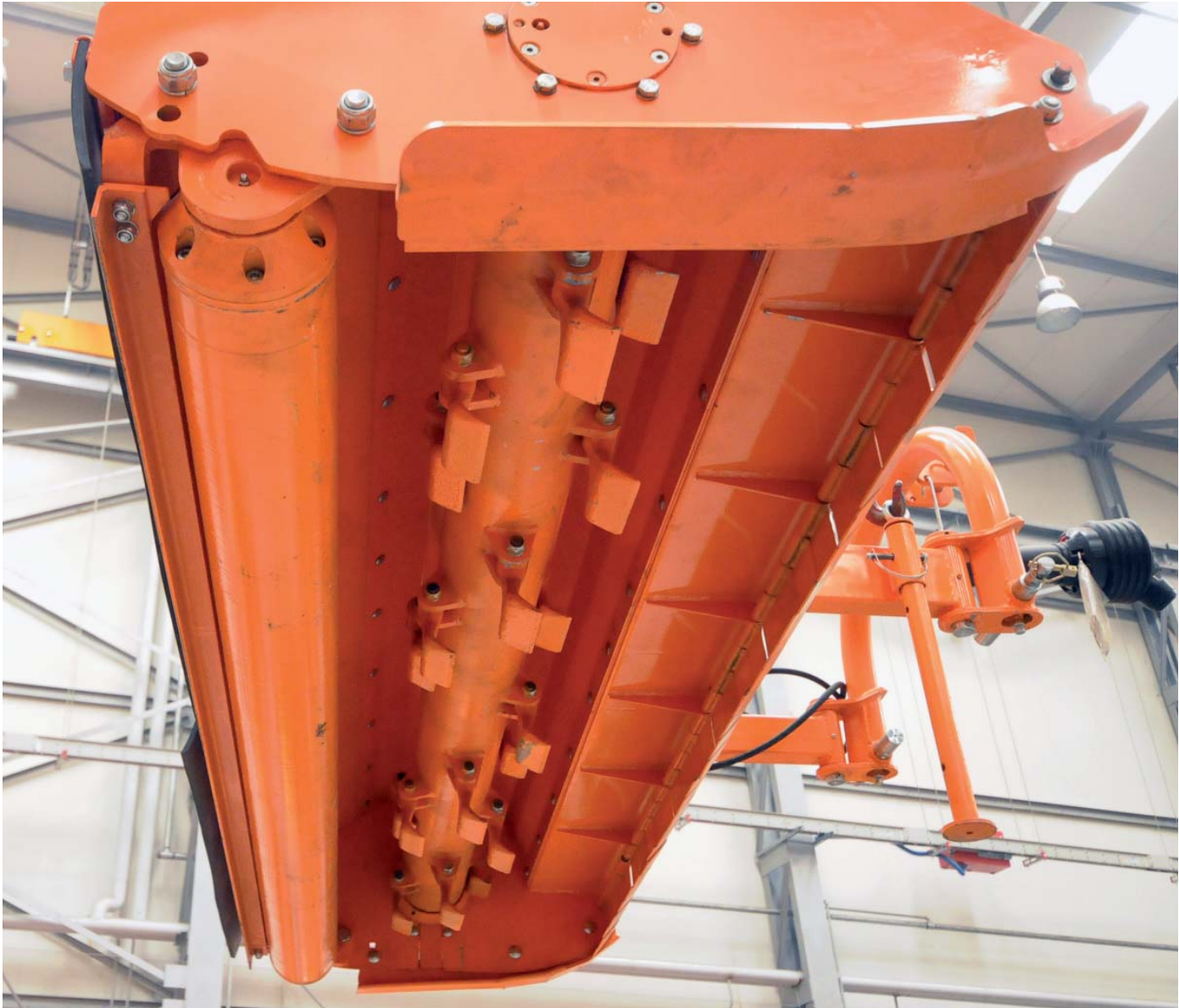
Widok na wał roboczy oraz młotki bijakowe
