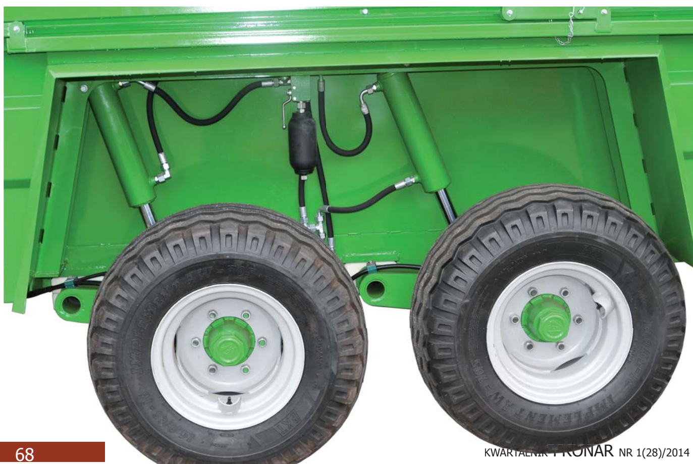
PRONAR T046/2 - zastosowane siłowniki hydrauliczne tłumią drgania i wpływają na stabilność skrzyni, co znacząco poprawia komfort transportowanych zwierząt
