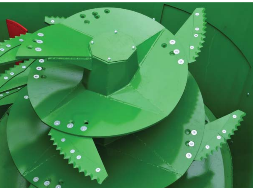
Widok na mieszadło Ślimakowe w VMP-10S w którym wymienne są same ostrza
