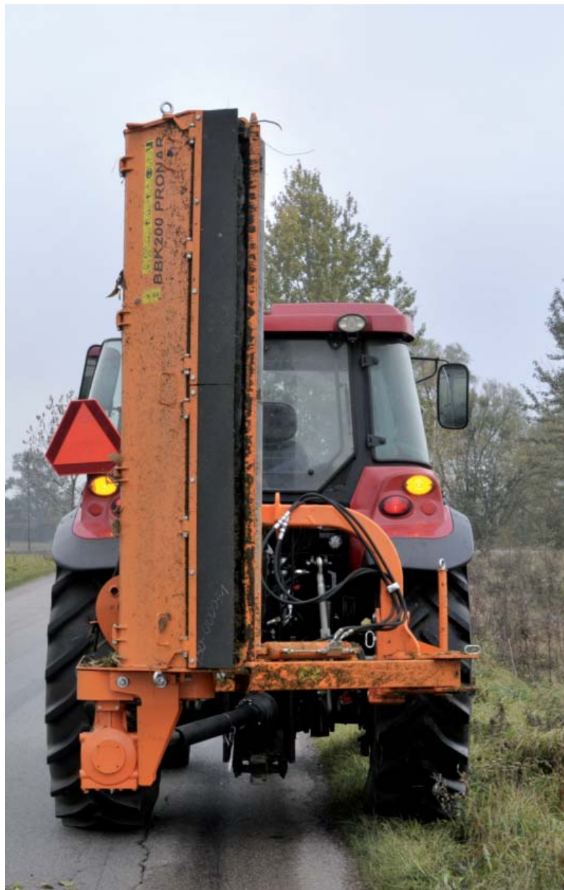
Pozycja transportowa kosiarki bijakowej tylnio-bocznej PRONAR BBK200
