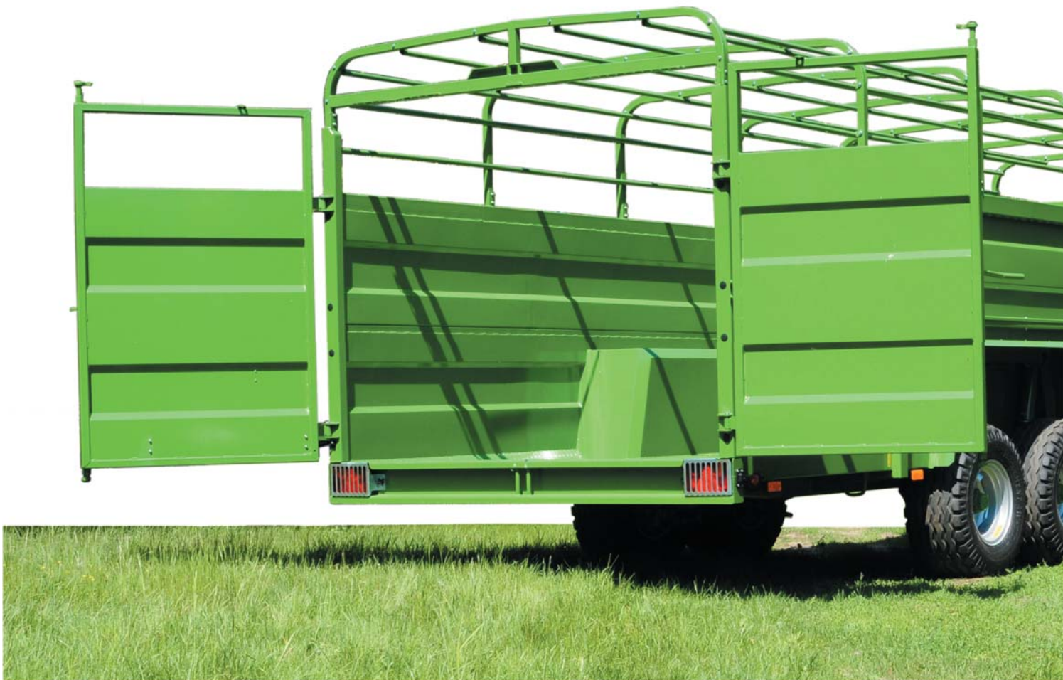
Tylne drzwi otwierane na boki ułatwiają załadunek
