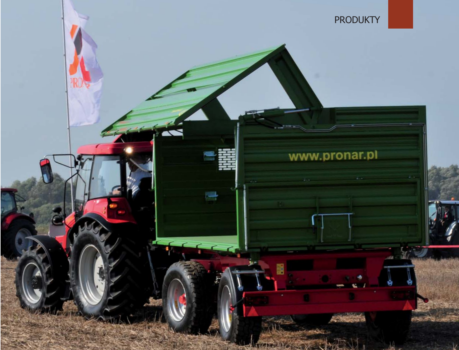
Lewa ściana boczna przyczepy PRONAR T680H jako jednolita profilowana płyta, jest unoszona i ryglowana przy pomocy instalacji hydraulicznej
