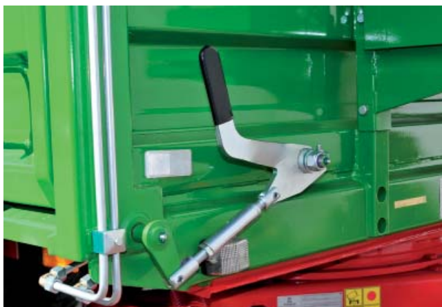
Mechanizm centralnego ryglowania, bądź odryglowywania prawej ściany bocznej w przyczepie T680H
