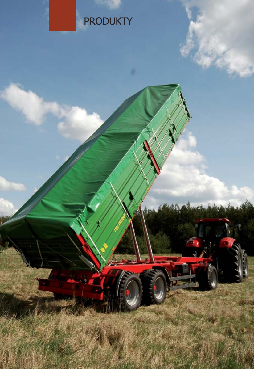
Przyczepa PRONAR T780 posiada w standardzie sprężyny wspomagające otwieranie burt
