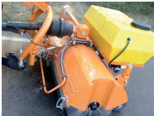
Dodatkowe wyposażenie zamiatarek w układ zraszający znacząco zmniejsza uciążliwość ich pracy dla otoczenia
