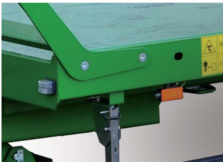
Dwupunktowy system mocowania drabinek, dający przy odpowiednim zamocowaniu ładunku możliwość rezygnacji z cięgien podtrzymujących
