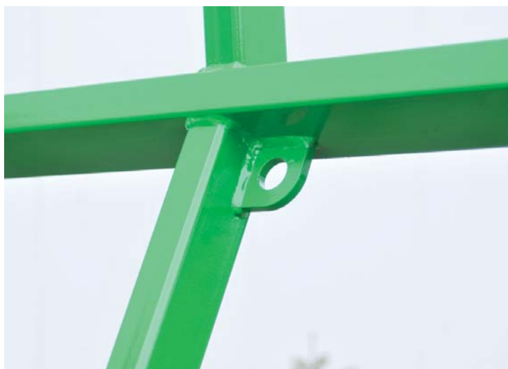
Dodatkowe otwory transportowe na drabinkach oporowych w przyczepie PRONAR T024M
