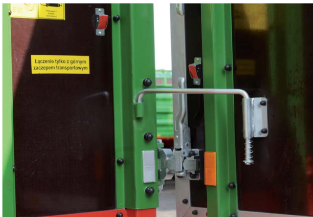
Blokada burty portalowej przyczepy PRONAR T680P zapobiegająca samoczynnemu zamykaniu się burty i tym samym jej uszkodzeniu
