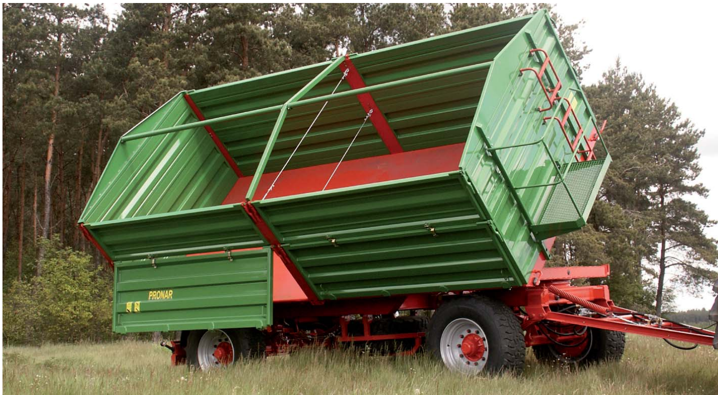
Przyczepa Pronar T680 z burtami dzielonymi, balkonem i stelażem plandeki podczas wywrotu na bok
