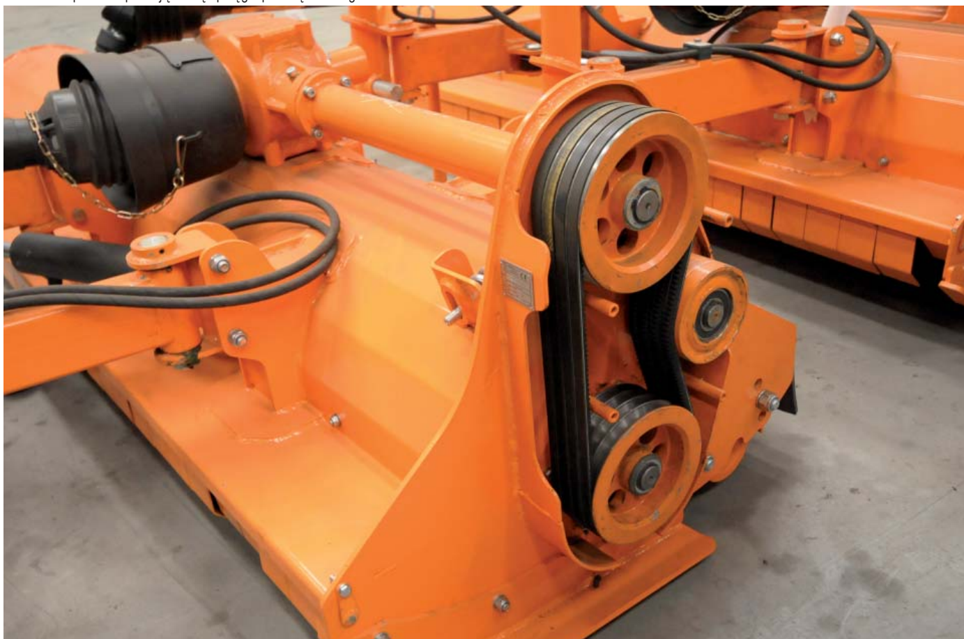
Przekładnia pasowa spełniająca rolę sprzęgła przeciążeniowego
