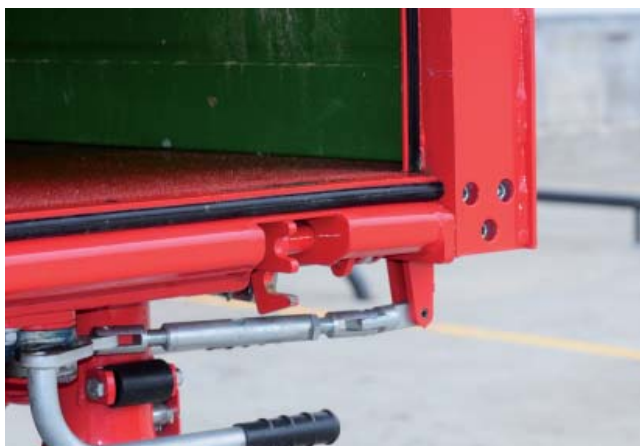
Wymienna gumowa uszczelka przy płycie podłogowej przyczepy PRONAR T680U zapewniająca szczelność skrzyni ładunkowej
